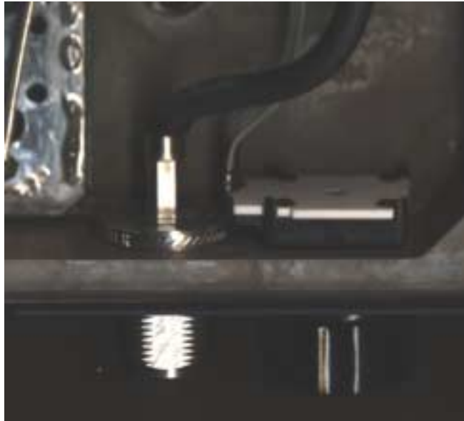
Afb.9 Rotary encoder, naast de zender uitgang.
